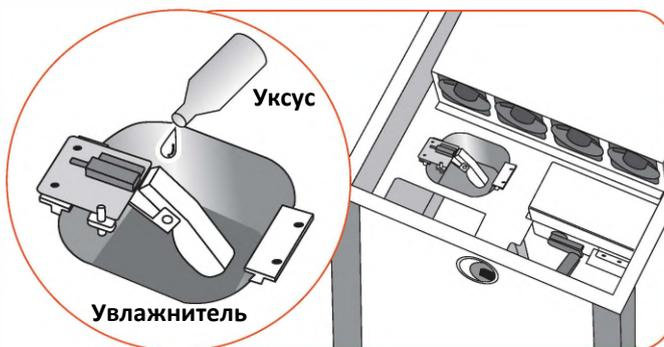
► Удалите пыль и посторонние предметы на блоке увлажнителя с помощью пылесоса, щетки и/или чистки с помощью уксуса.
