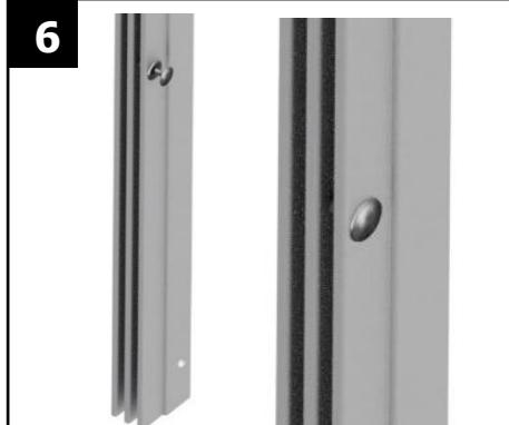
Установите заклепку в отверстие и нажмите на нее, чтобы зафиксировать.
