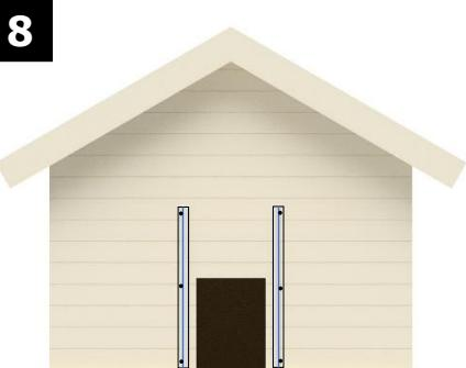
Расположите планки с продольными пазами на каждой стороне дверного проема птичника так, чтобы дверной проем располагался посередине между ними. Планки с продольными пазами должны быть расположены строго вертикально, ровно и в одной плоскости. Расстояние между крепежными отверстиями должно составлять 322–325 мм.
