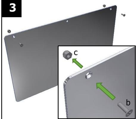
Установите винты с потайной головкой (b) и гайки (c) на вторую дверную панель. Винты вставляются с обратной стороны в отверстия под винты с потайной головкой.
