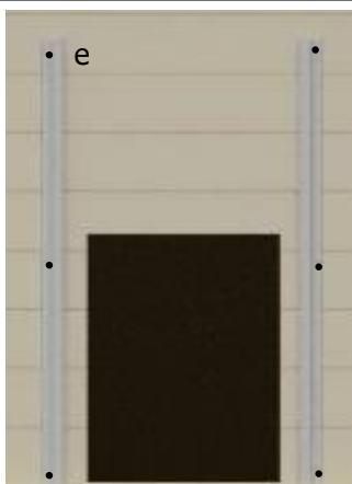
Закрепите планки с продольными пазами шестью черными шурупами для дерева (е).
