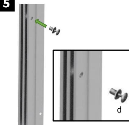
Вставьте пластиковую заклепку (d) в отверстие в каждой планке с пазами (как показано на рисунке).
