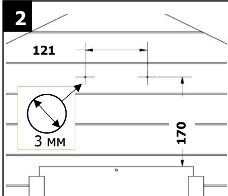
Разметьте два отверстия на расстоянии 121 мм друг от друга и примерно на 170 мм от верха раздвижной двери.
