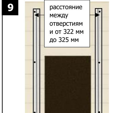
После того, как планки с продольными пазами будут установлены вертикально и расстояние между крепежными отверстиями будет составлять 322–325 мм, разметьте позиции для шести креплений. Просверлите отверстия диаметром 1,5 мм.
