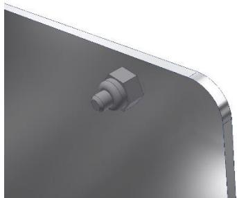
Затяните каждую гайку, поворачивая винт отверткой и удерживая гайку плоскогубцами или гаечным ключом.
