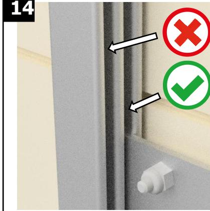
Эта панель должна вставляться во второй паз каждой планки. Винты и гайки должны быть расположены спереди.
