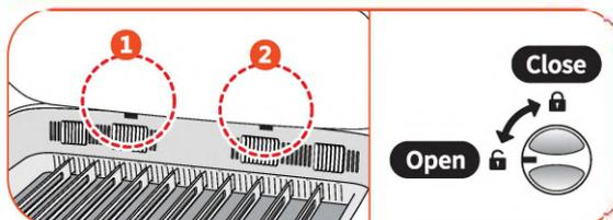
⚠ Совместите два выступа на задней стороне смотрового окошка с корпусом (вверху), как показано на рисунке. Сборка происходит не в обратном порядке. Не поднимайте устройство за ручку смотрового окна в заблокированном состоянии.
