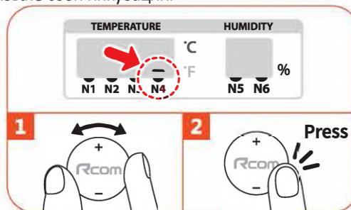
► После установки желаемого значения нажмите на поворотный переключатель один раз, чтобы сохранить настройку.
