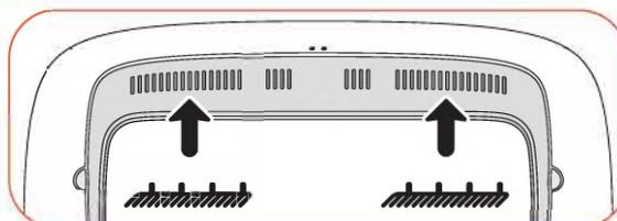
**⚠** Две воздушных решетки крепятся к основному корпусу (верхнему). Вы можете использовать инкубатор с прикрепленными решетками. Когда они снимаются для очистки, убедитесь, что после очистки снова закрепили в том же положении и направлении. В противном случае это может повлиять на скорость вывода
