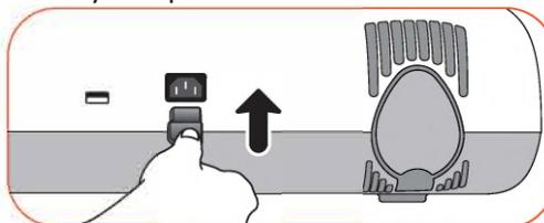
▶ Вставьте силовой шнур в розетку и в заднюю часть устройства.
