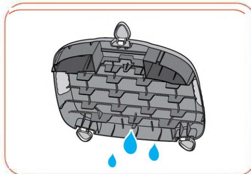
**Совет:** ВСЕГДА ИСПОЛЬЗУЙТЕ [РЕЖИМ СУШКИ] ПЕРЕД ХРАНЕНИЕМ после завершения инкубации. В противном случае могут быть спровоцированы неисправности электронного устройства и сенсорного блока из-за оставшейся внутри влаги.
