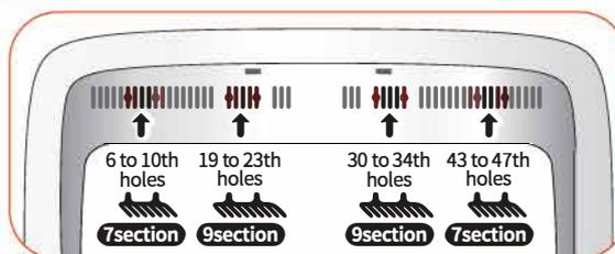
⚠ Четыре воздушных решетки крепятся к основному корпусу (верхнему). Вы можете использовать инкубатор с прикрепленными решетками. Когда они снимаются для очистки, убедитесь, что после очистки снова закрепили в том же положении и направлении. В противном случае это может повлиять на скорость вывода.
