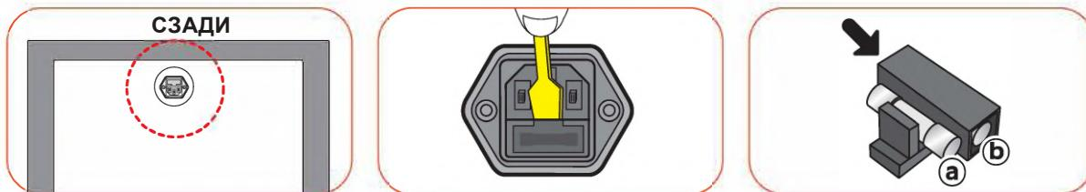
► Предохранитель расположен сверху на блоке подключения шнура питания на задней стенке инкубатора.
