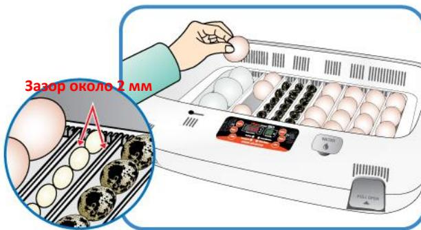
\* При использовании «универсального перекатывающегося разделителя», который продается отдельно, будьте осторожны при разграничении секторов, чтобы яйца не скатывались со своего места. См. рисунок.
