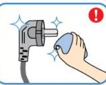
В случае попадания пыли на контакты силового шнура, протрите их сухой тканью.
